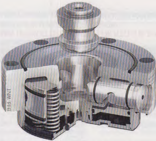
WNT ist mit seinem pneumatischen Spannsystem vertreten. Bei ihm können zusätzlich zur Federkraft die Kolbenflächen mit Druckluft beaufschlagt werden.
